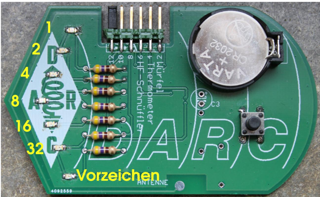
Eigentlich wurde diese spezielle Anzeige eher für Testzwecke eingebaut. Man kann sie aber für Temperaturen benutzen, die sich mit der „normalen“ Thermometerfunktion nicht anzeigen lassen: Temperaturen unter 18 Grad oder über 32 Grad.
